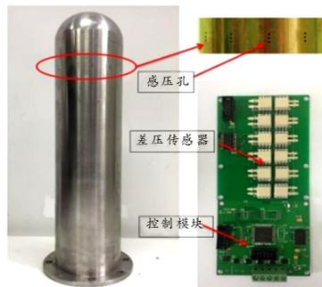
图 3 风速测试样机原理图及实物图
